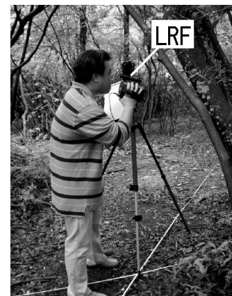
写真2 LRFによる測量風景
